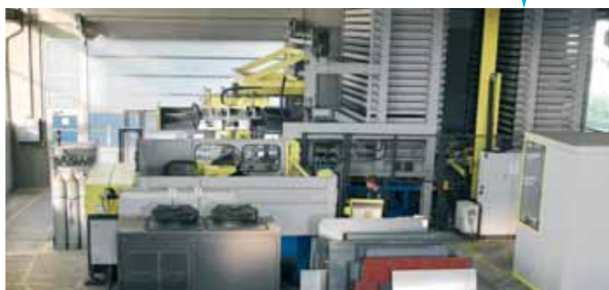
Раскрой на лазерном обрабатывающем центре
