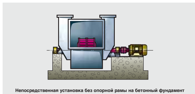
Непосредственная установка без опорной рамы на бетонный фундамент
