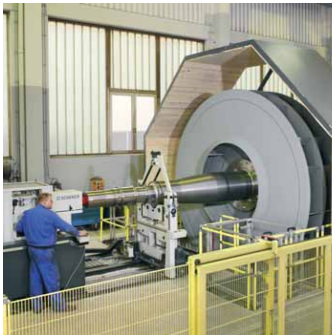
Балансировка роторного узла
