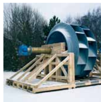
Готовый к отгрузке роторный узел на транспортной раме
