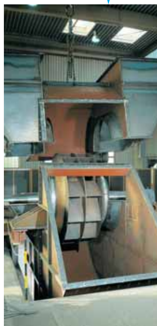
Пробный монтаж двухпоточного центробежного вентилятора
