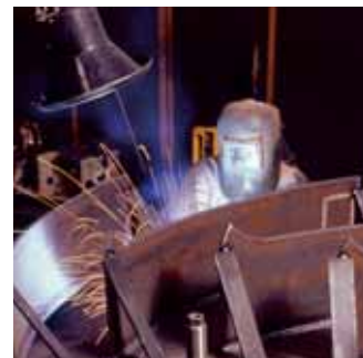
Изготовление рабочего колеса в виде сварной конструкции
