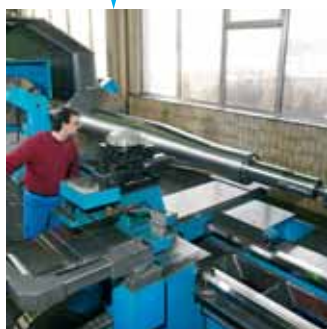
Доводка кованого фланцевого вала, а также готового сварного рабочего колеса
